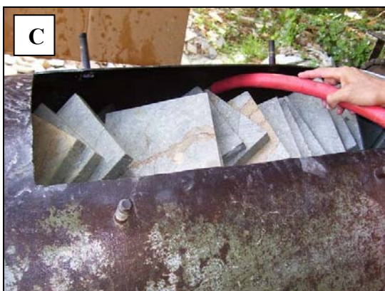
FIGURA 30. Processos de acabamento e produtos resultantes. A): abujardado; B): troquelado; C): atomorado.
