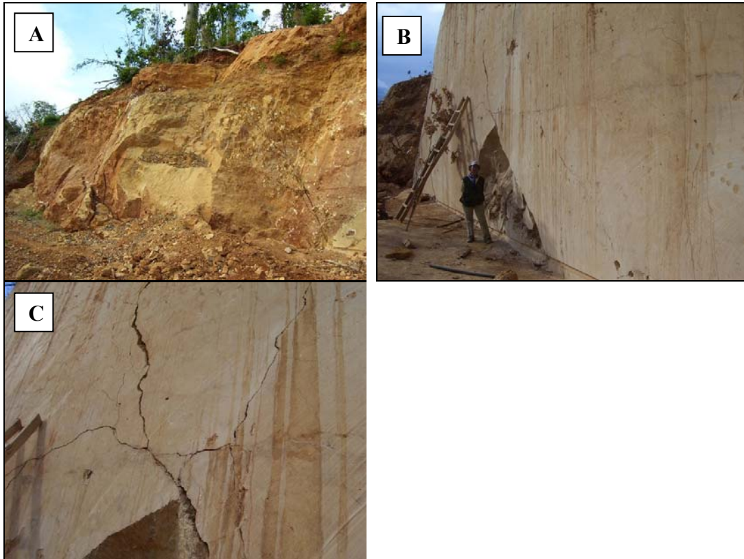
FIGURA 27. Generalidades da Área de Lavra 2, produtora do calcário Royal Dorado. A) Vista geral da Área de Lavra. B) Extração da rocha com fio diamantado na Frente de Lavra. C) Fissuras geradas no processo de extração do calcário Royal Dorado.
