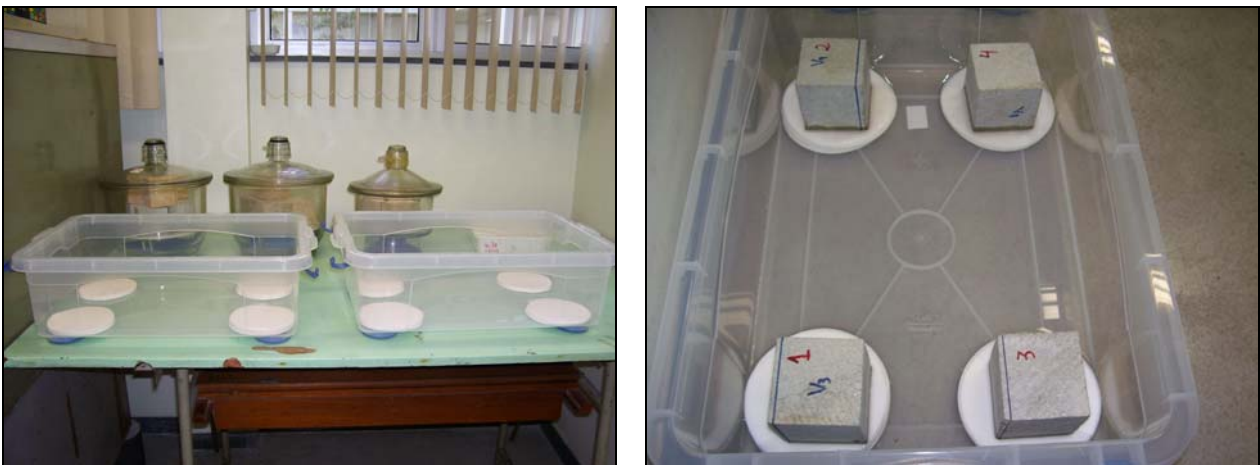
FIGURA 2. Montagem do ensaio de absorção por capilaridade. Os corpos de prova são colocados sobre papel de filtro saturado em água a nível constante.
