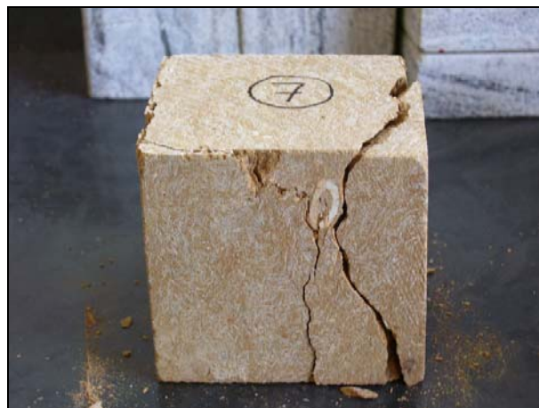
FIGURA 77. Ruptura do corpo de prova do calcário Royal Bronze (RB) contornando o fragmento fóssil (concha de gasterópodo).
