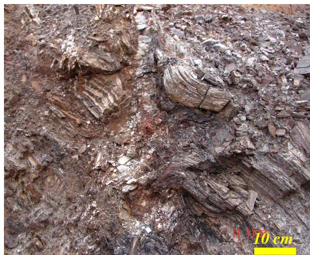
*Prancha 21 - Falha normal com mergulho acentuado, cortando a formação ferrífera mineralizada dentro da cava do Pit São Jorge e com preenchimento de veio de quartzo branco no plano de falha.*
