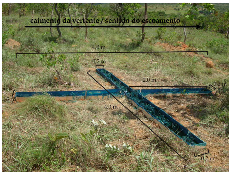
FOTO 4.3 - Estação em cruz montada com a estrutura em madeira e com o líquido traçador aplicado
