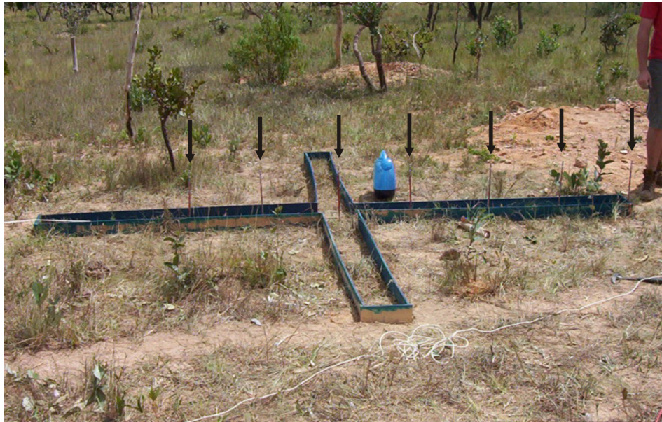
FOTO 4.5 - Disposição dos eletrodos dentro da caixa delimitadora da área a receber a solução aquosa (levantamento base). As setas indicam os eletrodos fincados no solo
