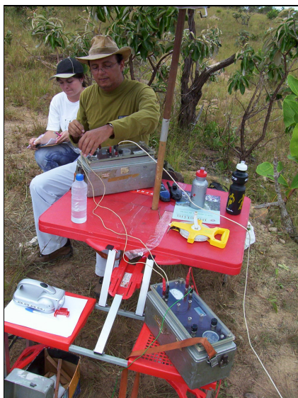
FOTO 4.7 - Operação das unidades de controle (voltímetro e potenciômetro) na obtenção de medidas - Resistivímetro ABEM
