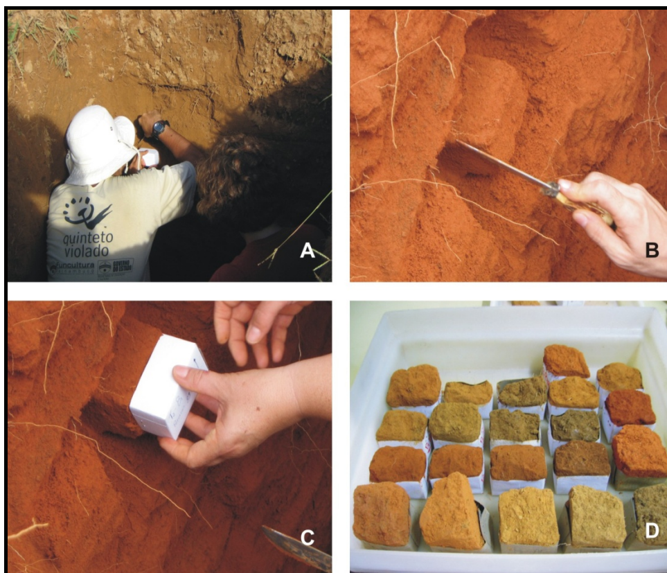
Figura 21: A e B – Coleta de amostras indeformadas diretamente da parede do perfil do solo; C e D – Uso da caixa de Kubiena para coleta e armazenamento das amostras.
