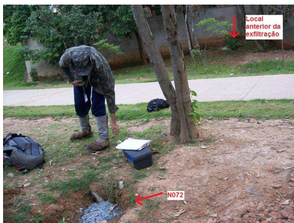
FIGURA 51 – Nascente antropogênica (N072) formada por um cano que drena a água do local anterior em que ocorria a exfiltração. Foto: Miguel F. Felipe
