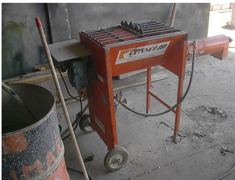
Figura 109-Argamassadeira utilizada no preparo da argamassa industrializada.
