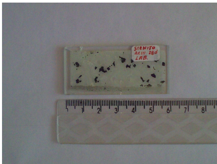
Figura 89-Lâmina delgada preparada para análise ao microscópio petrográfico.
