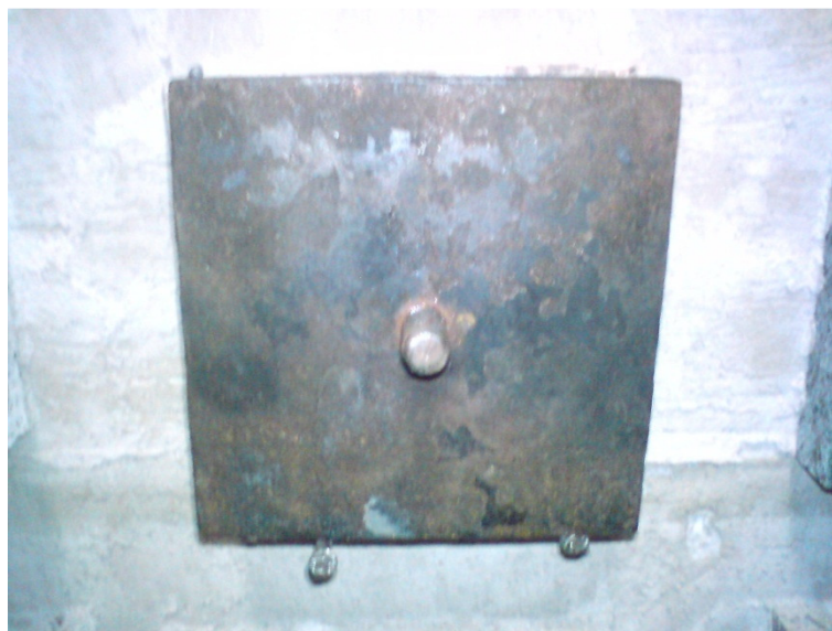
Figura 114-Placa de aço colada ao corpo-de-prova de rocha.
