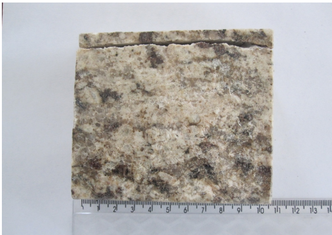
Figura 117-Demonstração do corte a seco de uma fatia transversal do corpo-de-prova de rocha + argamassa.
