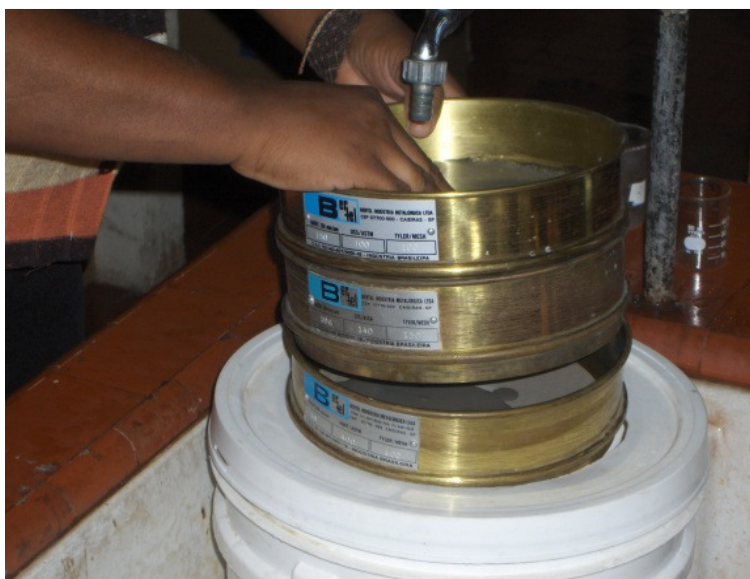
Figura 103-Peneiramento e separação de partículas via úmida.
