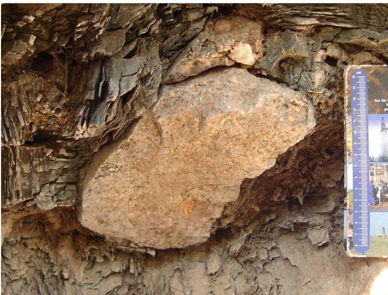
Figura 22 –Matacão subanguloso de quartzito isolado em camada de filito (Figura 20).
