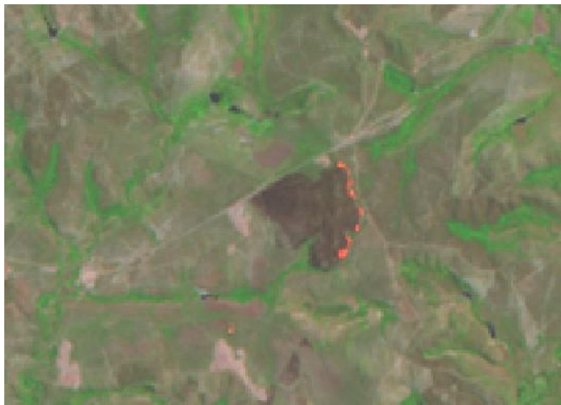
FIGURA 41 – Detalhe do mosaico de 1989 da área de estudo em composição RGB 743 mostrando área de queimada com a linha de propagação do fogo.
