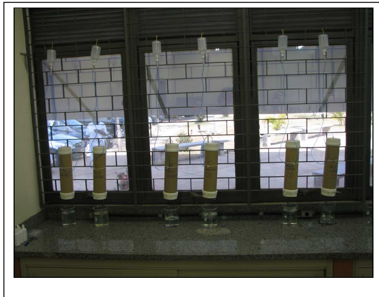
FIGURA 15 – Adição de 1000 ml de água destilada por gotejamento rápido no topo das colunas de lixiviação e coleta do lixiviado em becker de 1 litro.
