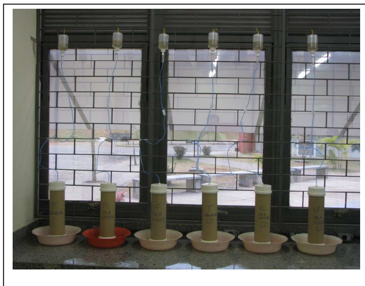
FIGURA 14 – Adição de 1000 ml de solução contaminante (cromo, chumbo e manganês) por gotejamento lento no topo das colunas de lixiviação.
