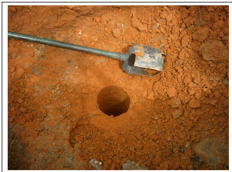
FIGURA 13 - Trado utilizado na amostragem de solo durante o monitoramento de retenção de poluentes na área de implantação da trincheira de infiltração e da vala de detenção na Estação Ecológica da UFMG.
