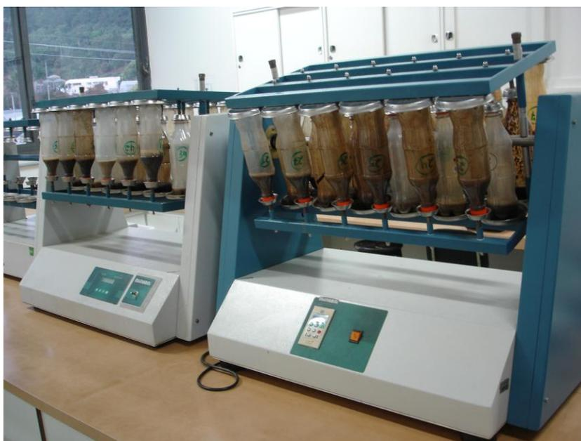
**Figura 7:** Agitador para agitação lenta.
