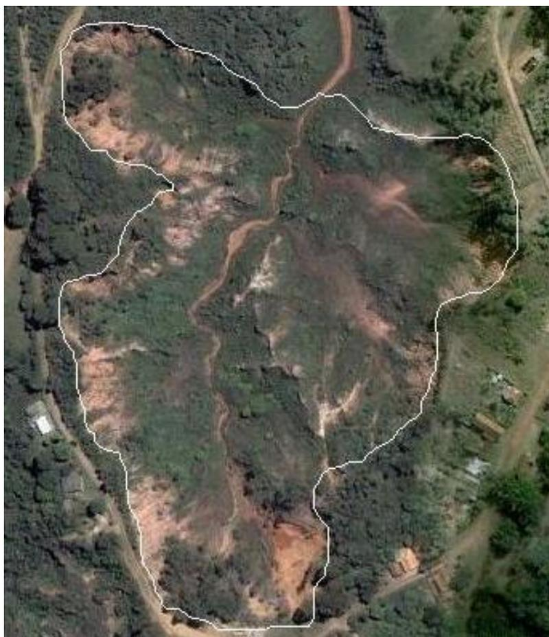
**Figura 41:** Voçoroca parcialmente ativa no Alto Córrego Prata (Coordenadas UTM fuso 23 K: 634538.43 E / 7746230.43 S). **Fonte:** Imagem Google Earth, Setembro de 2011.
