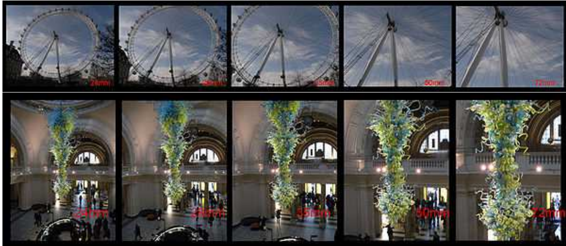
Figura 26 - comparações entre as lentes de 24mm, 28mm, 35mm, 50mm e 72mm. Fonte: Disponível em : http://en.wikipedia.org/wiki/Angle_of_view . Acesso em set. 2010.
