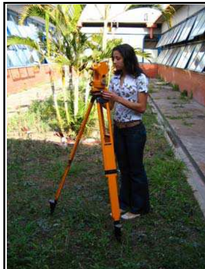
Figura 28 - Tripé nivelado na altura do observador e suporte de câmera. Fonte: Carneiro, 2005.
