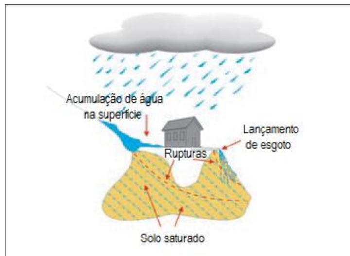
**Figura 7 – Perfil esquemático do processo de ruptura de terreno pela ação da água da chuva e lançamento de esgoto**
