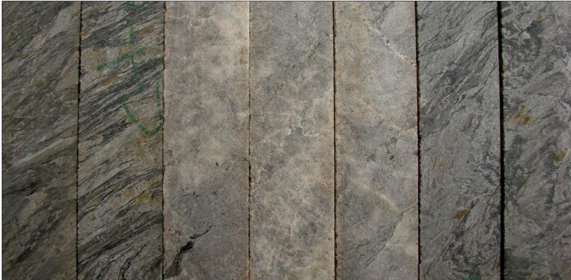
FIGURA 5.4: Prancha com amostras de testemunhos de sondagem exibindo veio de quartzo-carbonato-sulfeto com Au–As–Sb. O veio de quartzo fumê tem massas de bertierita hospedado em xisto carbonoso dobrado e transposto. Há sericitização, silicificação e sulfetação na hospedeira. Furo de sondagem FCS1234, intervalo 302,90–310,40 m. Seção 5100 (vide FIG 4.1)
