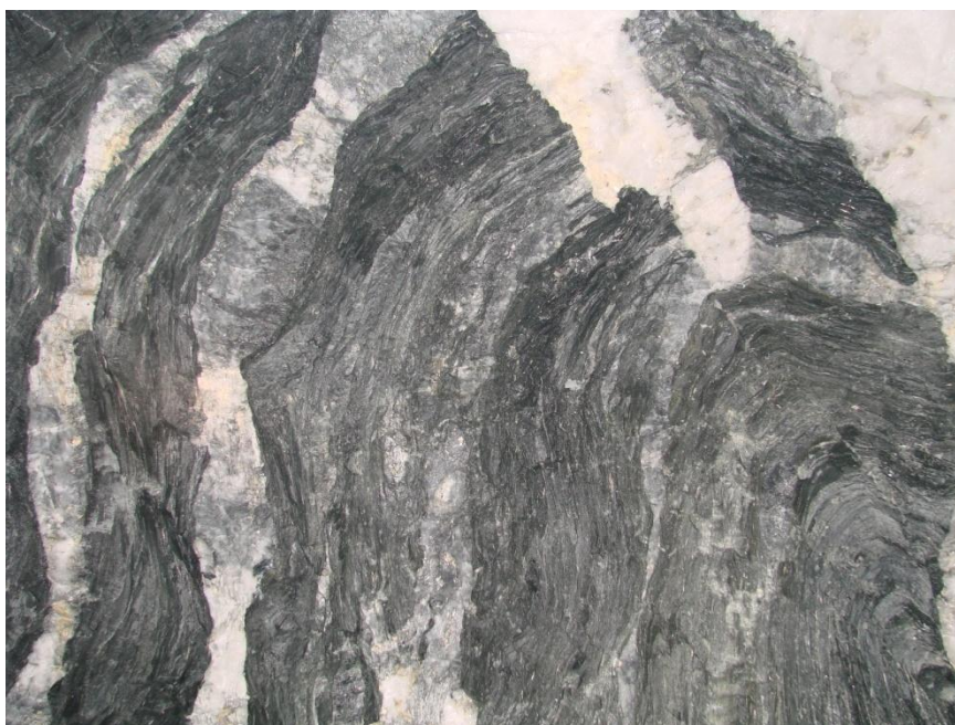
FIGURA 5.8: Veio de quartzo fumê boudinado encaixado em metagrauvaca (plagioclásio-sericita-quartzo xisto carbonoso) com disseminações de arsenopirita (FeAsS); Galeria Mina Cachorro Bravo, nível 738 corpo 101 sul.
