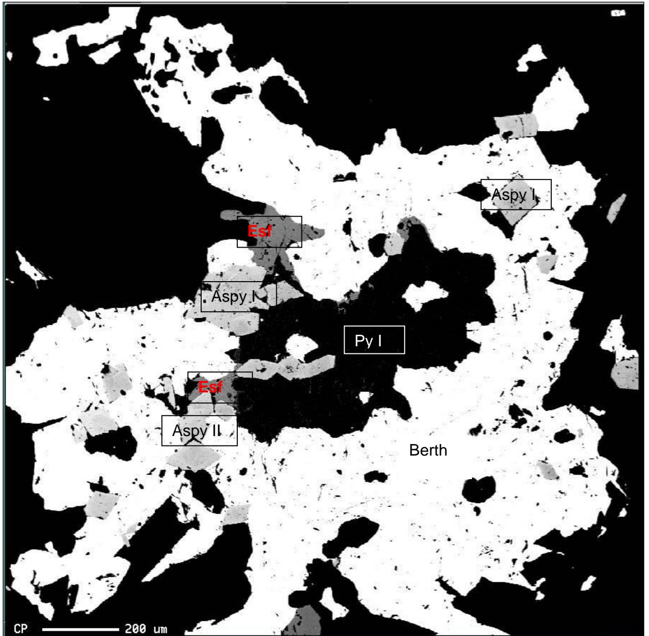
FIGURA 5.29: Amostra FCS928 – 239.80 Pirita porosa no centro com inclusões de tetraedrita, calcopirita, arsenopirita envolvida em aglomerado de Berthierita com esfalerita e arsenopirita euédrica, ullmanita e boulangerita na borda de Berthierita. Cristais euédricos de arsenopirita sobre berthierita e pirrotita. Imagem retro espalhada em MEV..
