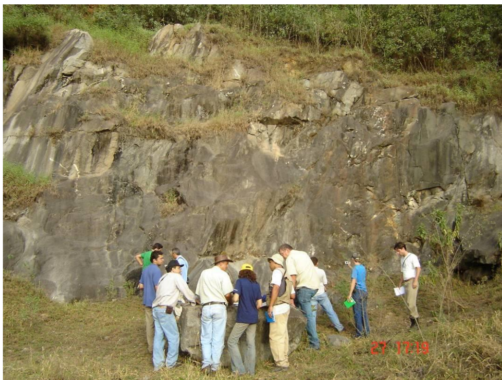
FIGURA 2.5 – Afloramento do Granito Alto Maranhão em contato com apófises e diques de rochas básicas.
