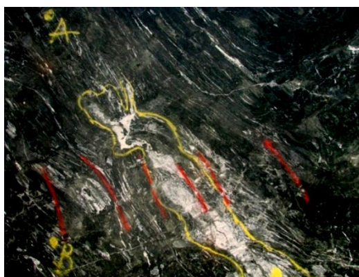
FIGURA 5.6: Veio de quartzo fumê boudinado encaixado em quartzo-sericita xisto carbonoso com disseminações de arsenopirita (FeAsS). Galeria Mina Cachorro Bravo, nível 673 corpo 211 norte.
