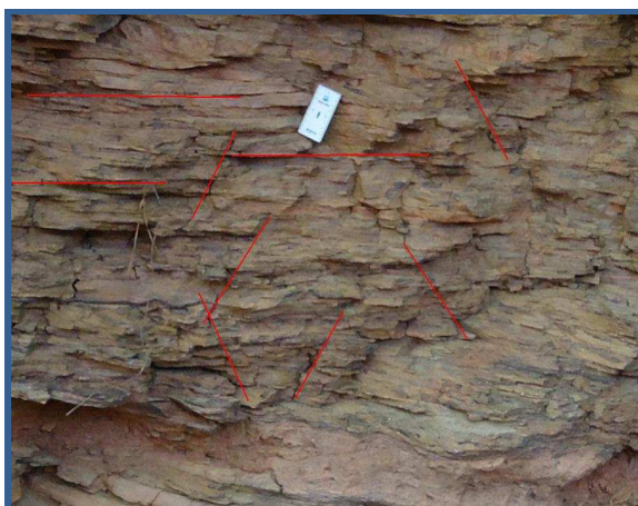
Figura 4.3: Metapelito alterado e pastilhado (em vermelho destacam-se os planos de fraturas).
