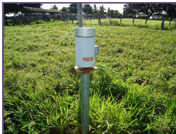
Figura 2.7: Pluviógrafo instalado a montante da bacia do riacho Boi Morto (P-118).
