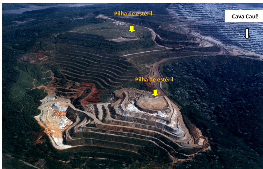
FIGURA 6.5. Nota-se no entorno da cava a reconstituição topográfica da Mina do Cauê através de material estéril.
