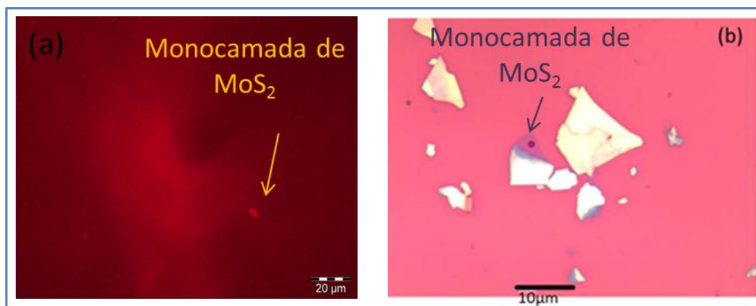
Fig. 5.8: (a) Imagem de monocamada utilizando um microscópio óptico com detector de luminescência. A seta aponta o local onde se localiza a monocamada. (b) A mesma imagem mostrando a monocamada e MoS 2 de multicamadas que estão em volta dela.
