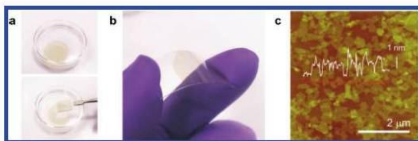
Fig. 2.6: Em (a) é apresentado uma fotografia de um filme de \text{MoS}_2 flutuando em água (imagem de cima) e depositada em uma placa de vidro (imagem de baixo). Em (b) a fotografia do filme colocado em um pedaço de garrafa PET e em (c) Imagem de AFM de um filme com espessura média de 1,3 nm. O filme consiste de regiões que são monocamadas misturadas a outras de mais camadas (retirada de 17).
