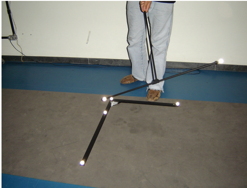
Figura 2: Processo de calibração do sistema da análise de movimento Qualisys
