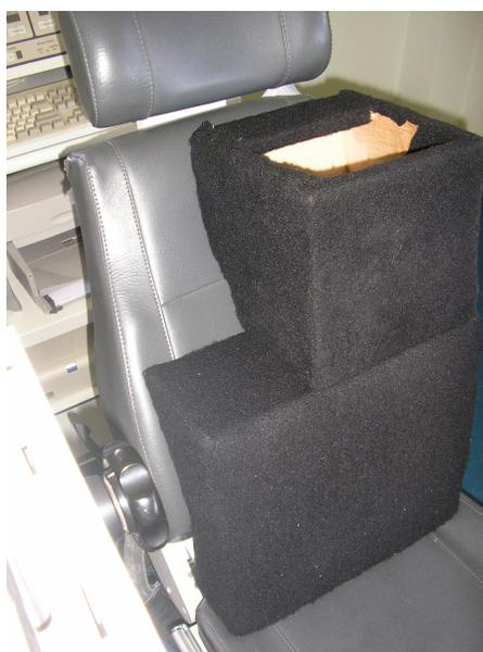
FIGURA 3: adaptação de madeira para o encosto da cadeira do dinamômetro isocinético
