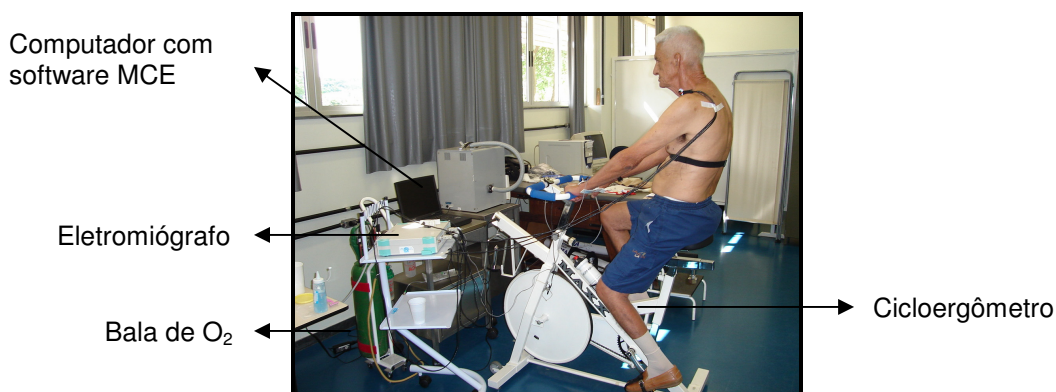
Figura 03: cicloergômetro associado ao MCE e ao eletromiógrafo
