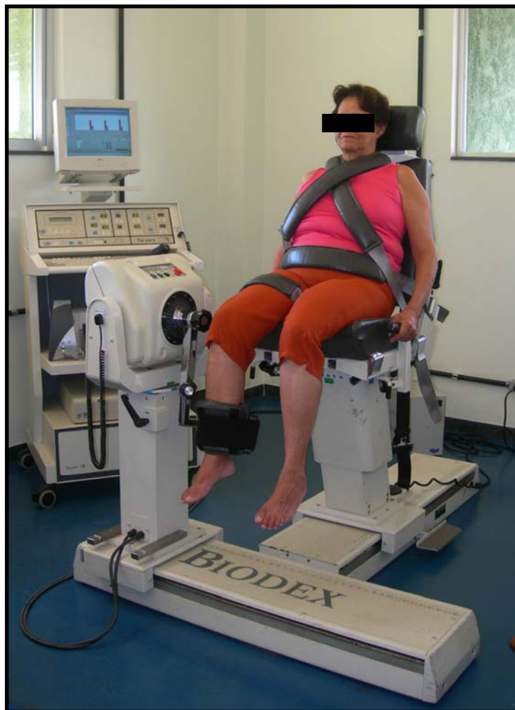
Figura 1- Posicionamento da participante para realização do teste de força no dinamômetro isocinético
