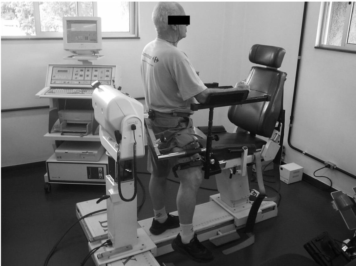
Figura 7. Voluntário realizando o movimento de abdução e adução do quadril no dinamômetro isocinético, utilizando o dispositivo estabilizador.
