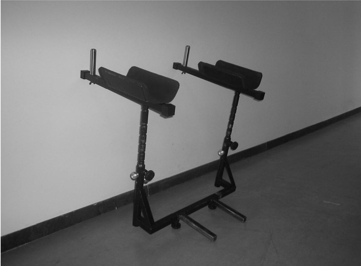
Figura 4. Dispositivo estabilizador (desenvolvido em parceria com o Departamento de Engenharia Mecânica da Escola de Engenharia da UFMG) para avaliação isocinética do quadril em posição ortostática.
