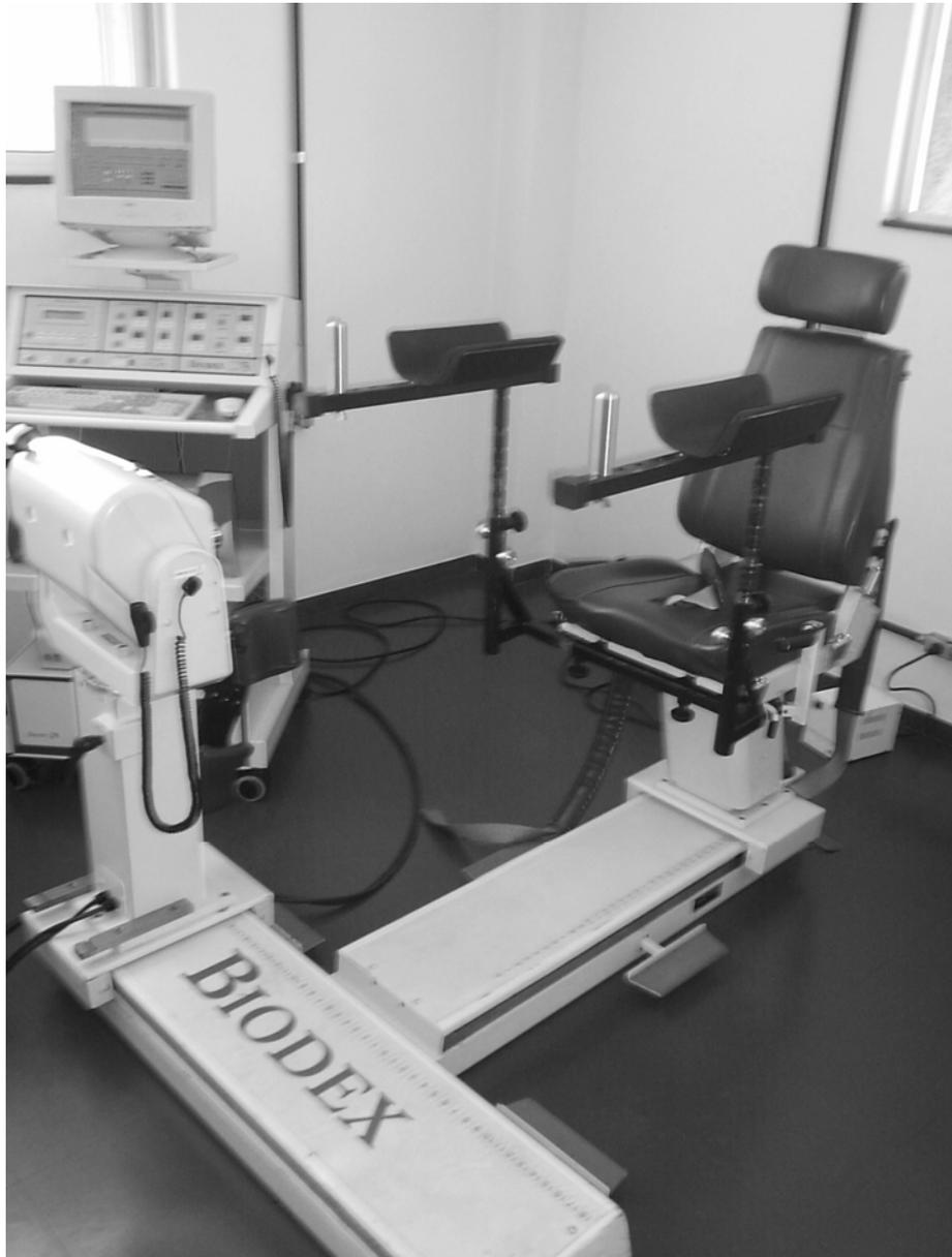
Figura 5. Dinamômetro isocinético *Biodex System 3 Pro®* com dispositivo estabilizador acoplado.
