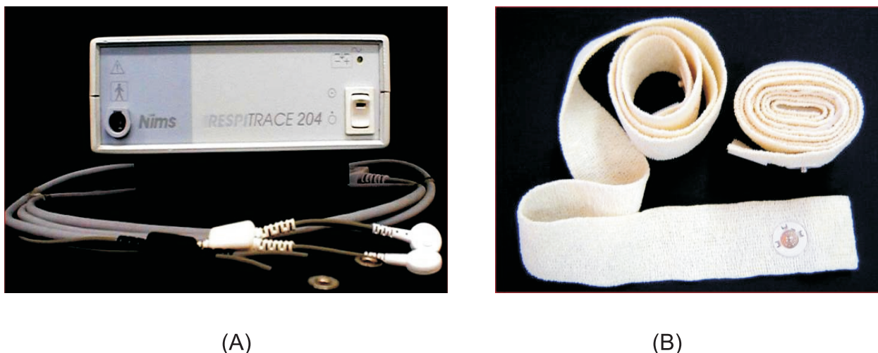
FIGURA 2 – (A) Aparelho usado na pletismografia respiratória por indutância ( Respirance® , NIMS, Miami, FL, USA). (B) Faixas de indutância usadas para registro das variáveis por meio da pletismografia respiratória por indutância.
