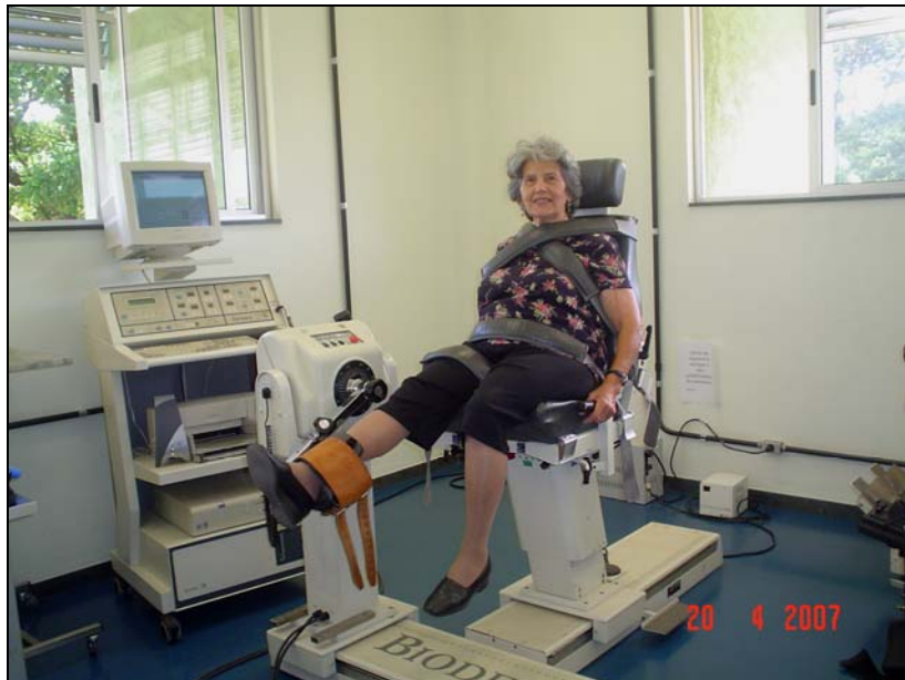
FIGURA 2 - Posicionamento da participante na realização da avaliação muscular no dinamômetro isocinético BIODEX 3 Pro (Medical System, Shirley, NY, USA)
