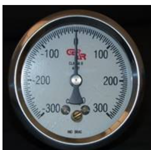
Figura 2: Manovacuômetro analógico GERAR ® Classe B - SP/Brasil
