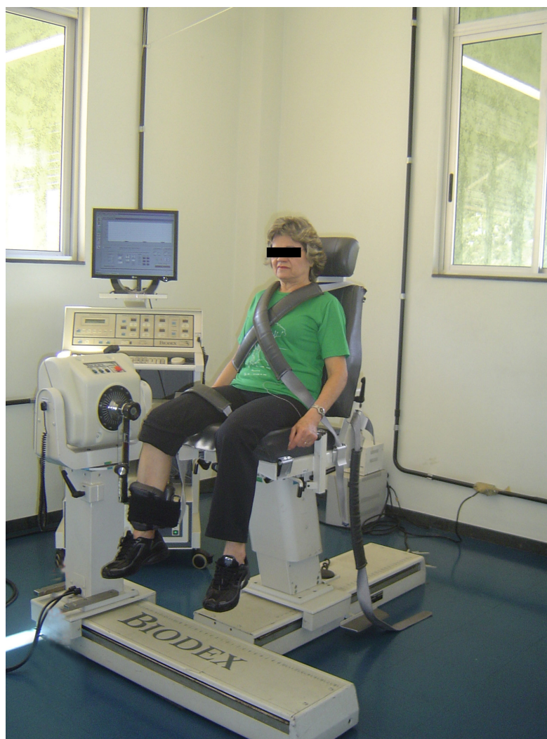
Figura 2- Voluntário realizando movimento de flexão e extensão do joelho no dinamômetro isocinético.
