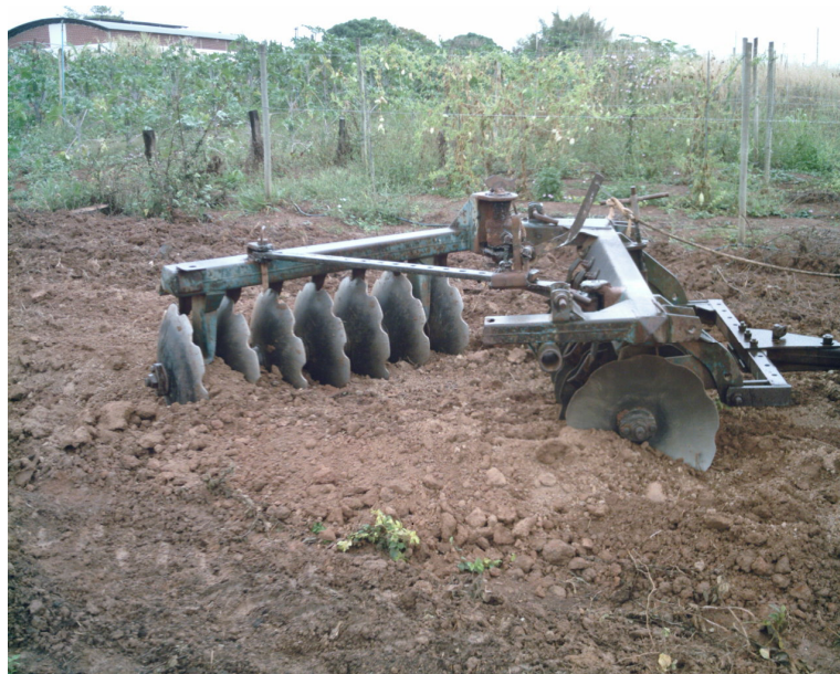
FIGURA 3 - Grade aradora Baldan® 14 discos Fonte: Arquivo do autor.
