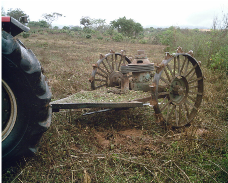
FIGURA 10 - Roçadora de arrasto SP1 – Inroda® Fonte: Arquivo do autor.
