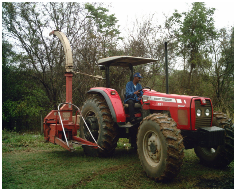
FIGURA 8 - Ensiladora de forragem Pecos 9004 ® – Nogueira Fonte: Arquivo do autor.
