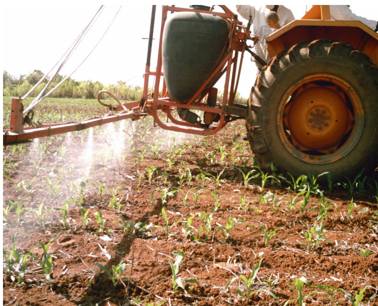
FIGURA 6 - Equipamento usado para aplicação de herbicida Fonte: Arquivo do autor.
