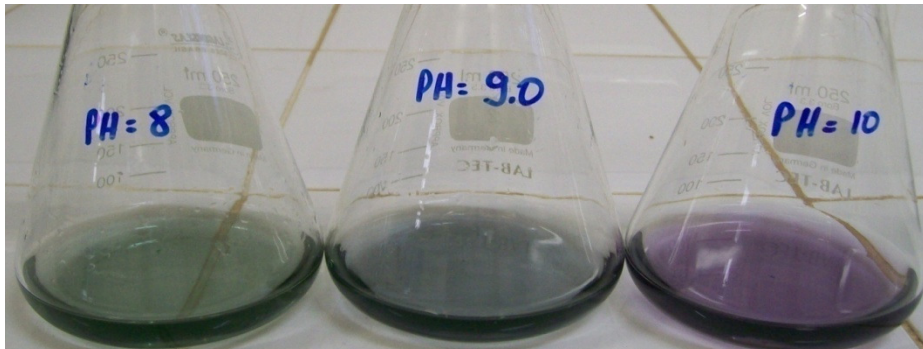
FIGURA 20 - Mudanças de coloração do indicador fenolftaleína nas suas faixas de viragem de pH( 8 a 10)
