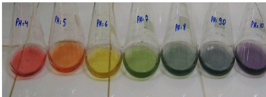
FIGURA 23 - Mudanças de coloração com todos indicadores nas faixas de pH (4 a 10)
