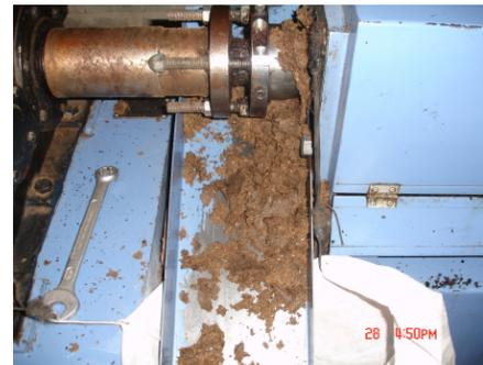
Máquina prensando a polpa +casca: separando óleo e torta
