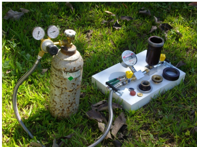
FIGURA 1- Câmara de pressão tipo Scholander (Arquivo pessoal).
