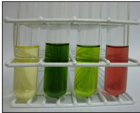
FIGURA 1 – Coloração dos extratos de A. brasiliiana produzidos por Dispersão da Matriz em Fase Sólida. Amarelo: extrato hexânico, verde-escuro: acetato de etila, verde-claro: etanol 98% e vermelho: etanol:água 70% v/v.
