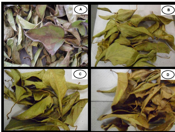
FIGURA 1 - Aspecto visual das folhas de guaco submetidas à secagem em Desidratador Pardal ® Modelo PGE60 profissional Nota: (A): secagem a 40°C; (B): secagem a 50°C; (C): secagem a 60°C; (D): secagem a 70°C. Fonte: Da autora.
