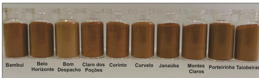
Figura 10 - Fotografia dos adsorventes preparados a partir do lodo de esgoto coletado em ETEs de dez cidades.
