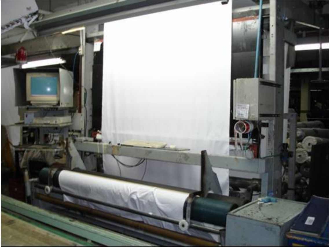
Figura 21: Foto do medidor / enrolador
