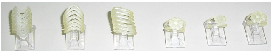
FIGURA 95 – Protótipos em resina (b). Modelos desenvolvidos no Senai “Américo René Gianetti” e produzidos por estereolitografia no Senai “Euvaldo Lodi”.
