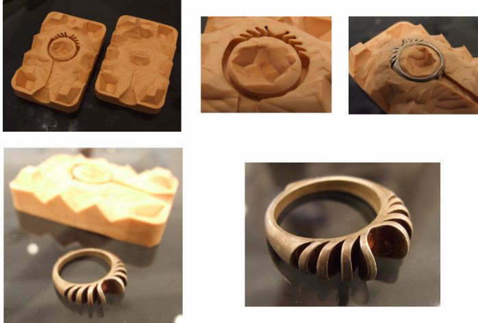
FIGURA 82 – Fotos da seqüência de produção de anel a partir do molde de borracha, produzido pelo Cedgem. Fonte: fotos gentilmente cedidas pelo Cedgem.
