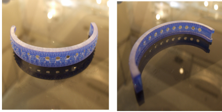
FIGURA 80 - Modelos construídos na nova máquina da 3Dsystems (que oferece melhor precisão e acabamento das peças).
