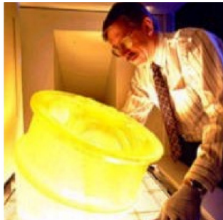
FIGURA 35 – Imagens do processo de estereolitografia. À esquerda, a incidência de raios laser a superfície de resina líquida. À direita, retirada de uma peça pronta, fabricada na máquina de estereolitografia.
