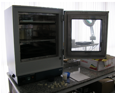
FIGURA 73 – Estufa, utilizada na limpeza e cura de protótipos (utilizada no Cedgem/UEMG). Fonte: foto produzida pela autora.
