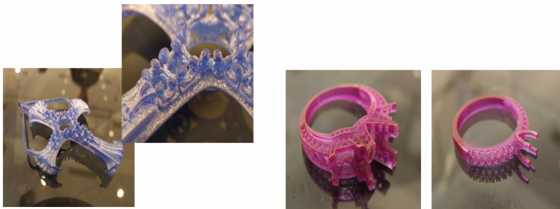
FIGURA 75 – Fotos de protótipos produzidos no Cedgem (a). Exemplos de precisão na construção de detalhes (grifas para cravação de gemas).
