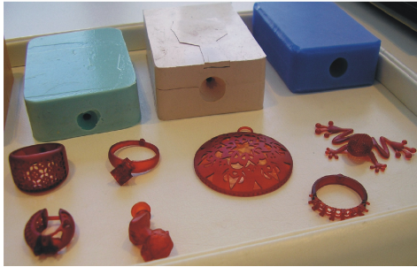
FIGURA 71 – Protótipos em resina e moldes de borracha. À esquerda e abaixo, protótipos de resina produzidos pela empresa Sculptec. Na mesma foto, acima, os moldes de borracha feitos a partir de protótipos de resina. À direita, um molde cortado ao centro, pronto para ser usado na máquina de injeção de cera. Fonte: fotos produzidas pela autora na empresa Sculptec.
