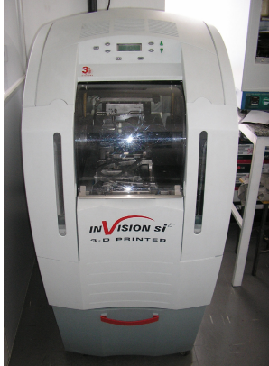
FIGURA 72 - Máquina Invision Si2 , da 3Dsystems (utilizada na UEMG para confecção de protótipos). Fonte: foto produzida pela autora.
