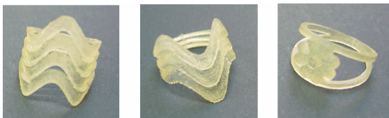
FIGURA 94 – Protótipos em resina (a). Modelos desenvolvidos no Senai “Américo René Gianetti” e produzidos por estereolitografia no Senai “Euvaldo Lodi”.
