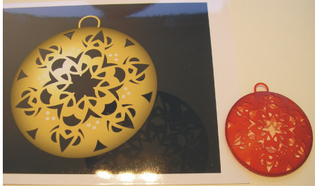
FIGURA 69 – Imagem renderizada e protótipo em resina. À esquerda impressão da imagem da peça construída e renderizada no software Rhinoceros, e ao lado protótipo em resina confeccionado na máquina da Envisiontec. Fonte: foto produzida pela autora na empresa Sculptec.
