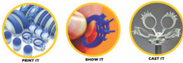
FIGURA 55 – Seqüência de produção de modelos de jóias usando sistema de impressão tridimensional. À esquerda, modelos cobertos com material de suporte. Ao centro modelo acabado. À direita árvore montada para produção em série.
