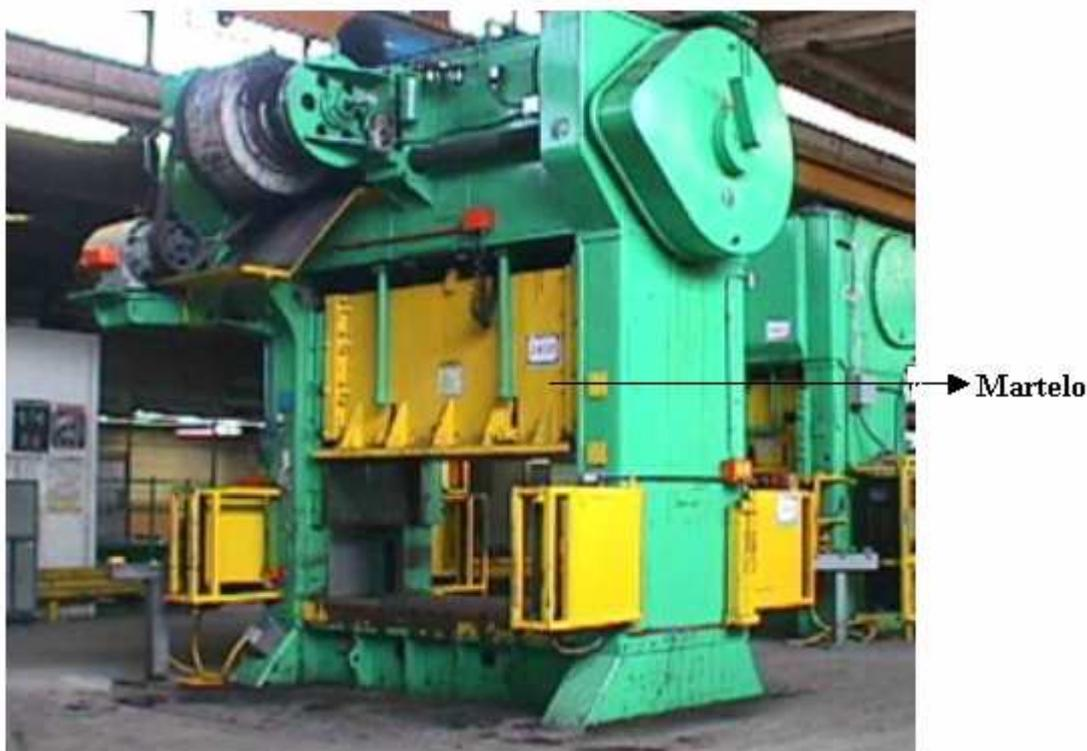
**FIGURA 1** – Prensa com demonstração do martelo
