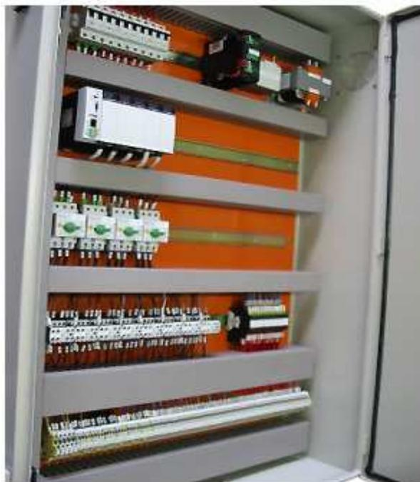
**FIGURA 8** – Painel elétrico de uma prensa com CLP (Comando Lógico Programável)
