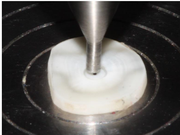
Figura 12 – Espécime posicionado para teste de push-out .
