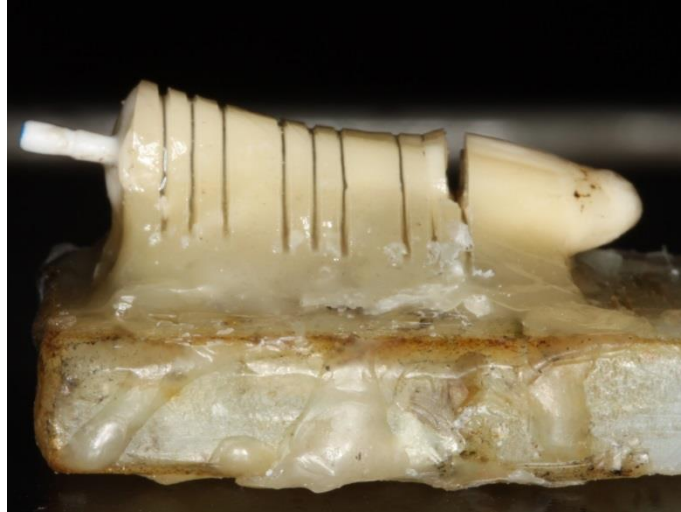
Figura 7 – Seções radiculares obtidas com espessura de aproximadamente 1,00mm.
