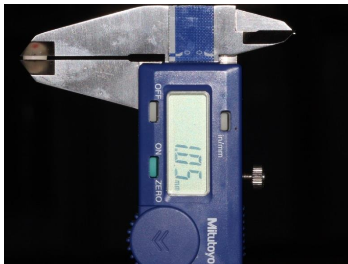
Figura 10 – Aferição da espessura dos espécimes com paquímetro digital.
