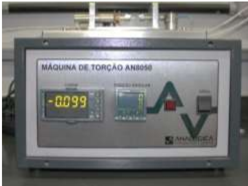
FIGURA 1A – Máquina de torção AN8050 utilizada nos testes
