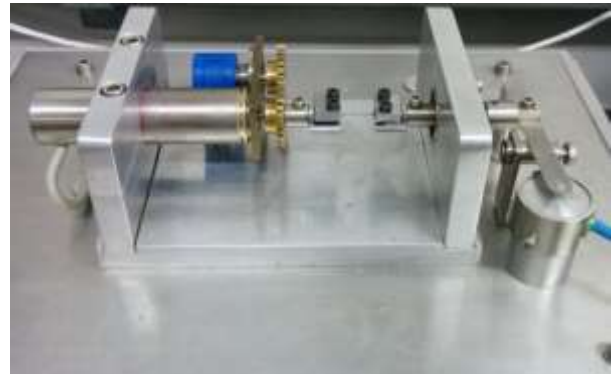
FIGURA 1B – Fio posicionado e teste de torção em andamento
