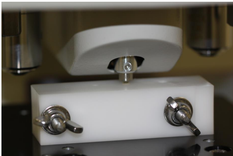
Figura 13 – Corpo de prova de cimento resinoso embutido mecanicamente na matriz bipartida, durante teste de microdureza Knoop
