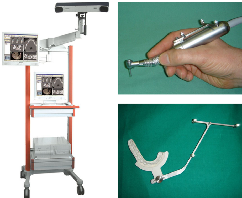
Figura 9: Sistema de navegação cirúrgico de orientação dinâmica. (A) Workstation, interface gráfica do usuário e câmera estereoscópica; (B) Broca cirúrgica com acompanhamento dos demais elementos; (C) referencial dinâmico montado numa dentadura. Fonte: VERCRUYSSSEN et al. , 2014.
