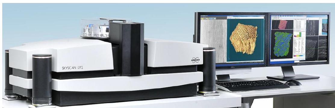
**Figura 11:** Micro-CT (SkyScan 1272 – Bruker) utilizado para análise do volume de cimento e das porosidades no interior do cimento e da interface dentina/cimento.
