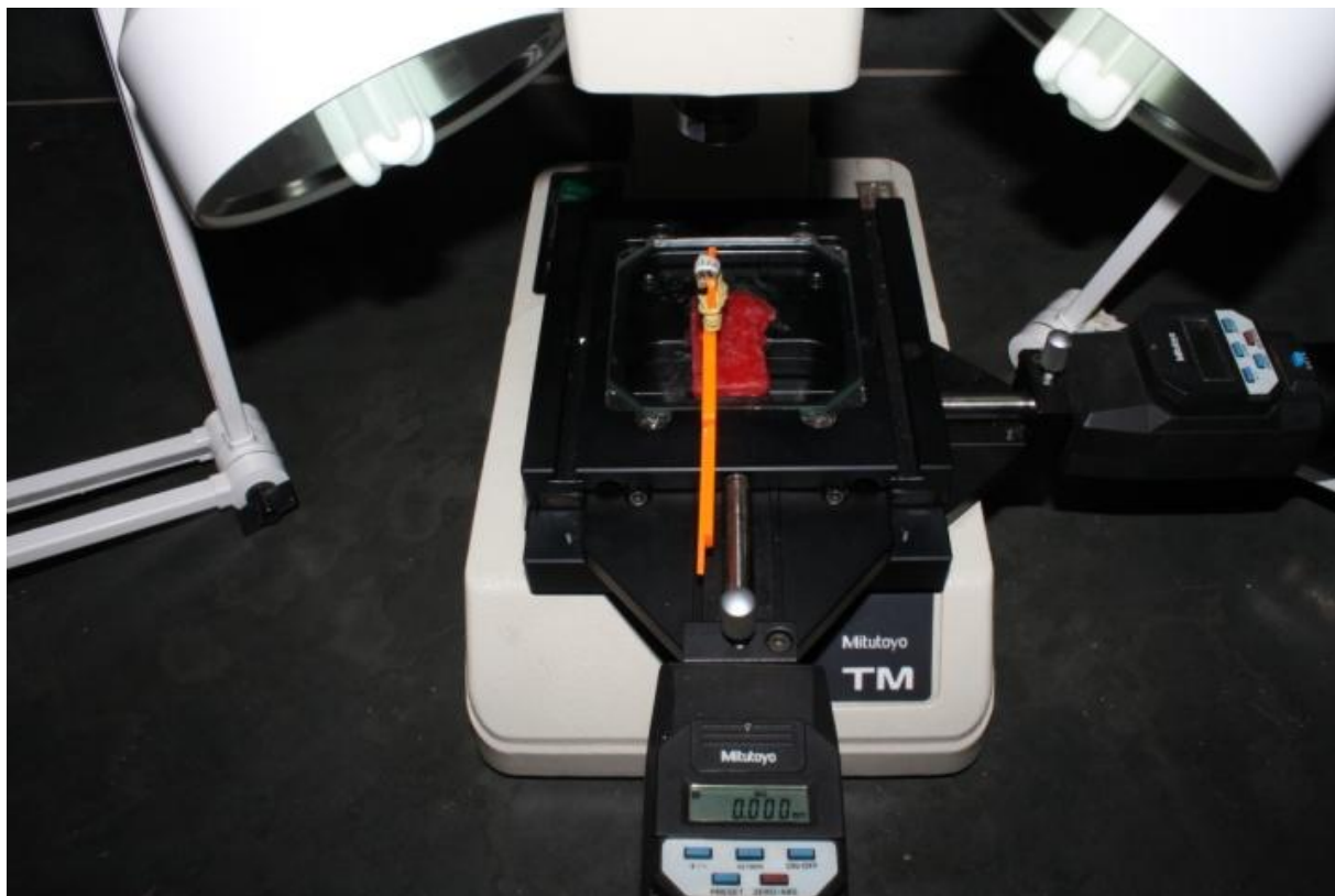
Figura 8- Observação no microscópio comparador digital Mitutoyo- TM 505.
