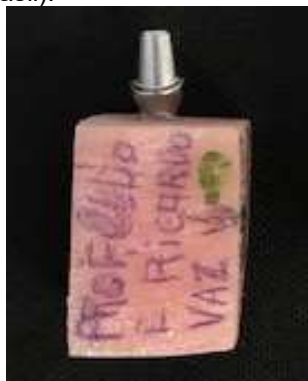
Figura 1 – Base de resina acrílica quimicamente ativada com instalação de implante do sistema cone morse e fixação de um munhão anatômico cone morse (Neodent-Curitiba, Brasil).
