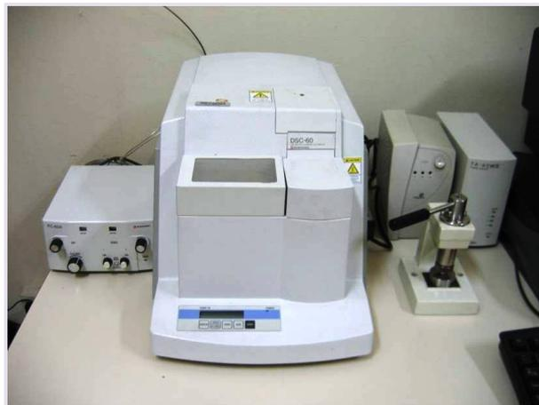
**FIGURA 8** – Aparelho de DSC utilizado na determinação das temperaturas de transformação de fase da liga.
