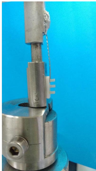
Figura 5 – Espécime acoplado à máquina de ensaio universal (EZ Test - S Shimadzu, Tokyo, Japão)
