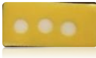
Figura 3 - Cerâmica zircônia com regiões delimitadas para a cimentação dos cilindros de resina composta.
