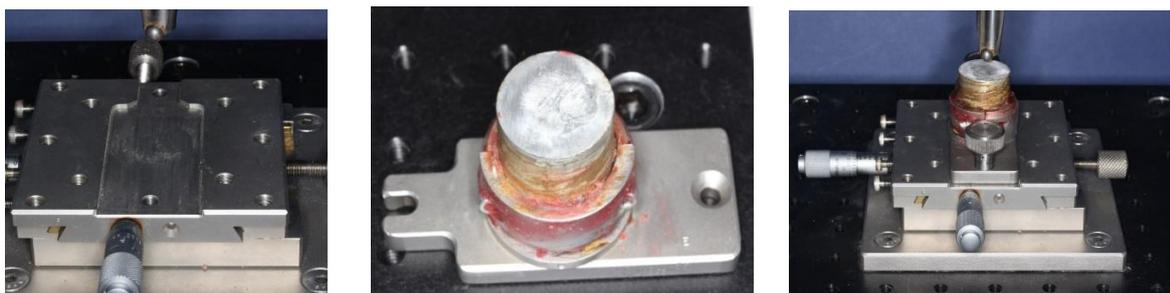
Fig.8: Dispositivo removível que permite a visualização da amostra em microscópio.
