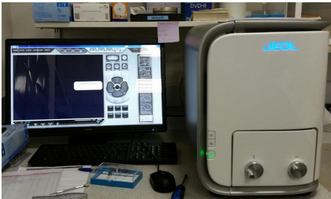
Fig.4: Microscópio eletrônico de varredura (NeoScope, JEOL, USA).
