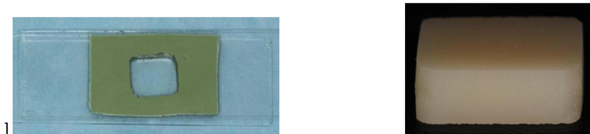
*Fig 6: Molde (direita) para a confecção dos blocos de resina (esquerda).*
