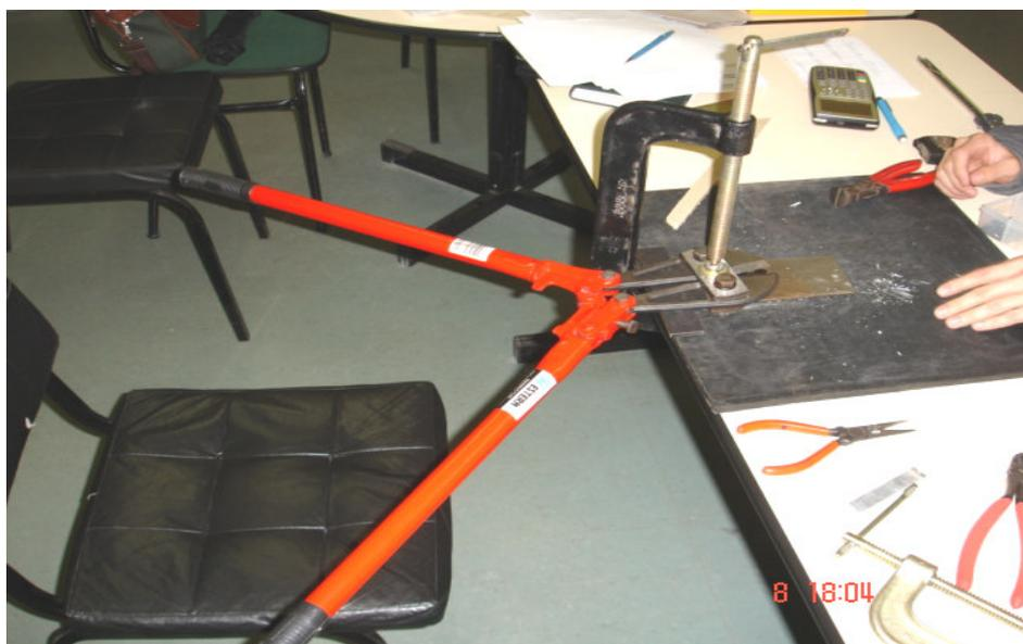
FIGURA 4.3– Alicate para corte das fibras.
