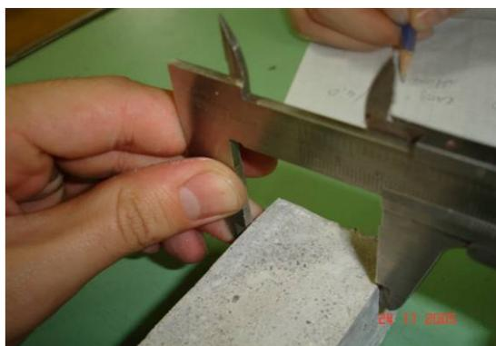
FIGURA 4.14 – Paquímetro para aquisição das dimensões dos CPs.
