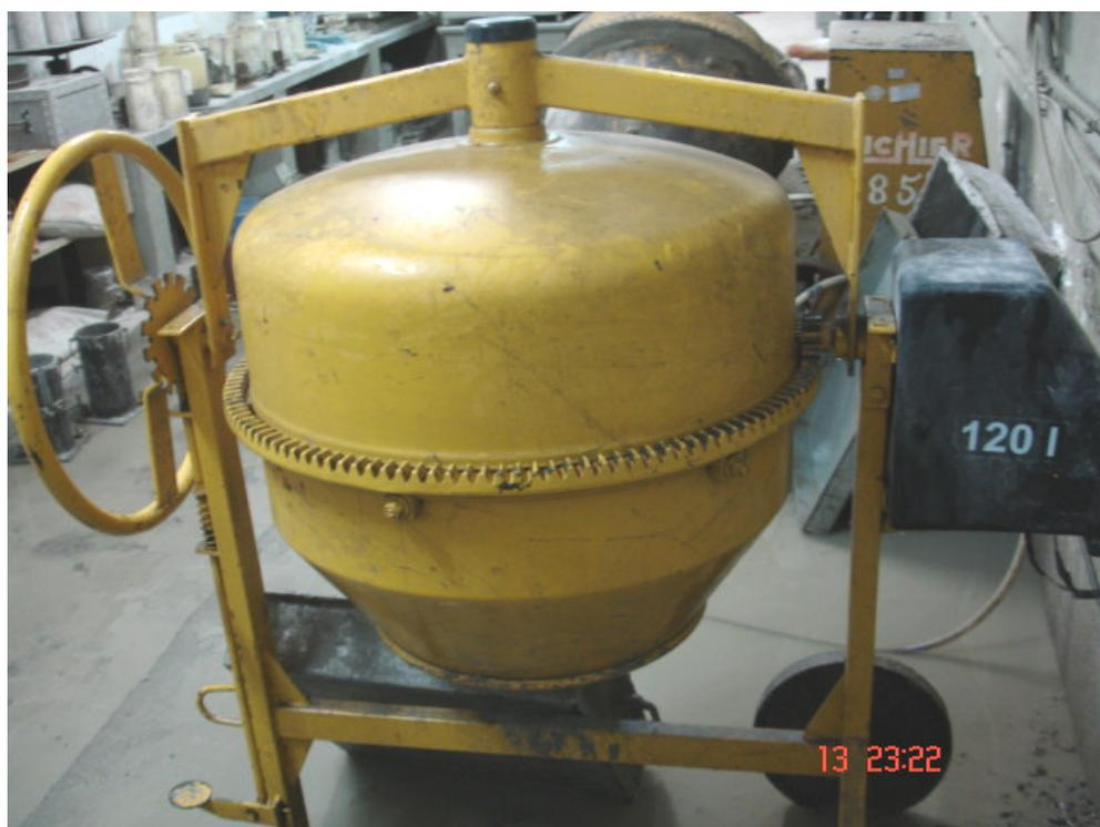
FIGURA 4.10 – Betoneira para mistura dos componentes do concreto.
