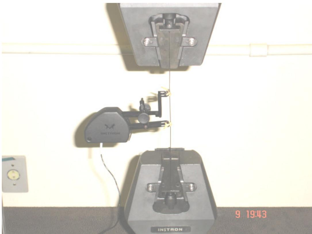
FIGURA 4.19– Liga Nitinol sendo deformada por tração de 8%.
