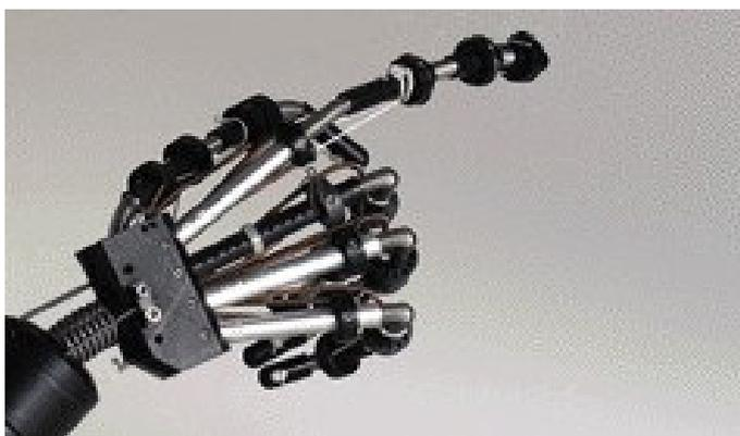
FIGURA 3.22 – Utilização da liga com EMF na robótica.
