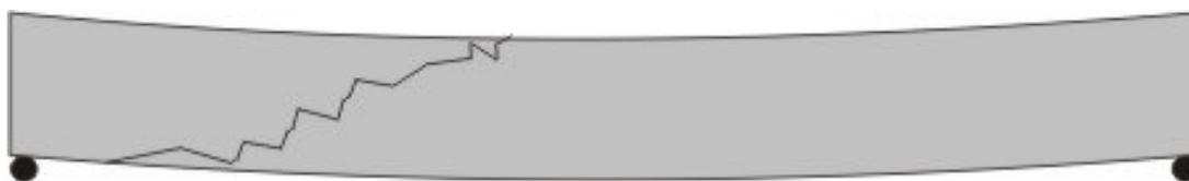
FIGURA 3.4 – Ruptura do concreto por excesso de tensão no apoio.
