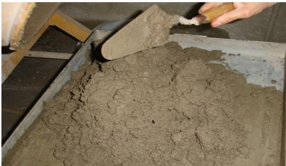
FIGURA 4.12– Concreto pronto para ser moldado.
