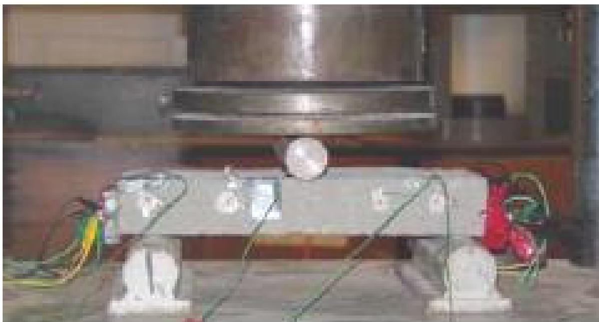
FIGURA 3.30 – Viga com aplicação de carga em três pontos.
