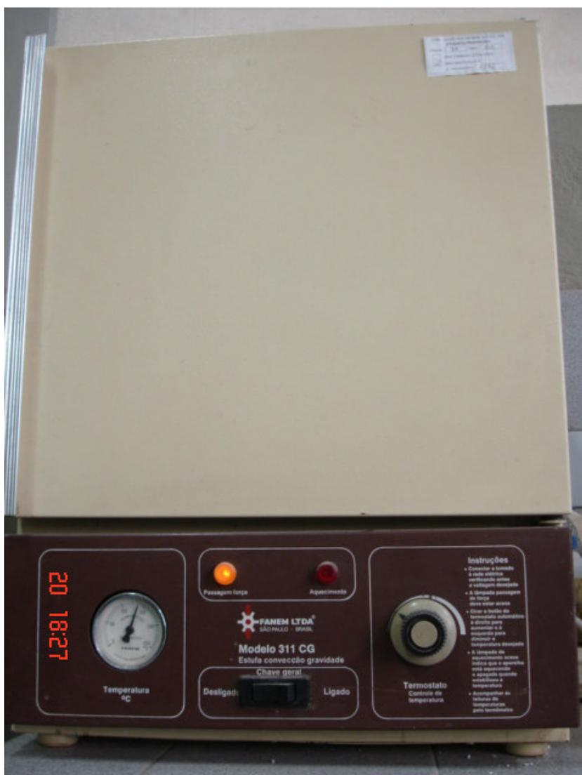
FIGURA 4.15 – Estufa usada para aquecer os corpos de prova.
