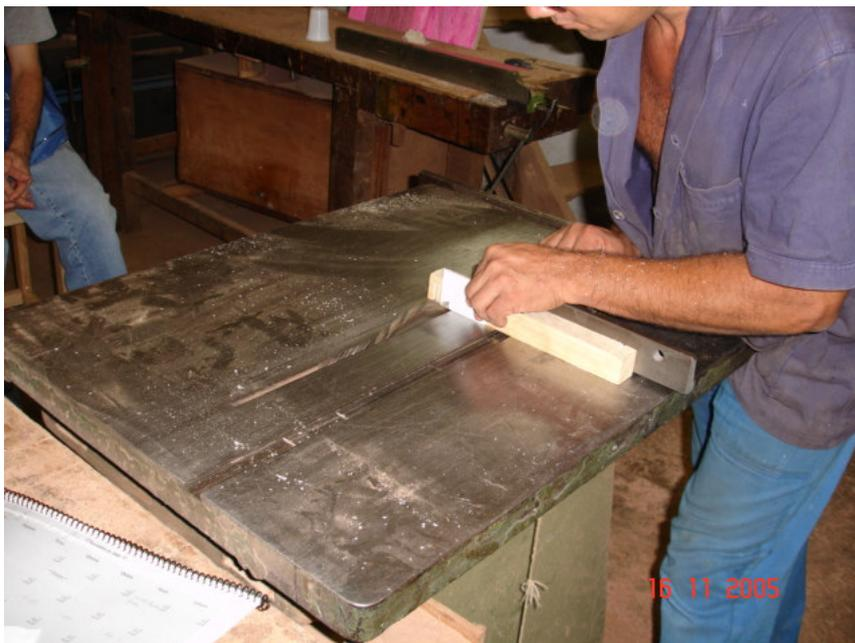
FIGURA 4.7 –Mesa com serra circular pronta para realizar o entalhe.
