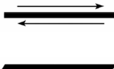
FIGURA 3.13 – Forças paralelas e opostas, onde o deslocamento de um objeto sofre cisalhamento.
