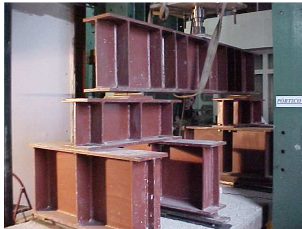
Figura 4.5 – Detalhe do sistema de aplicação de carga
