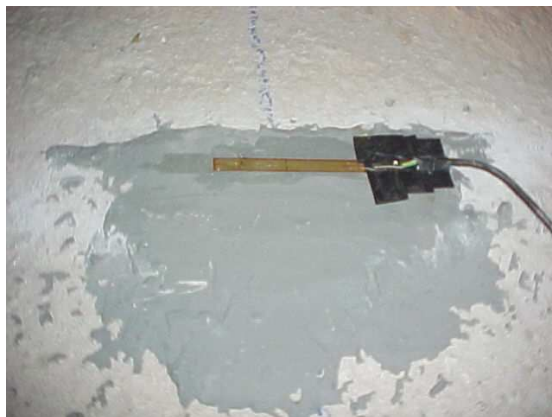
Figura 4.6 – Extensômetro elétrico (EER) colado na face superior da laje de concreto
