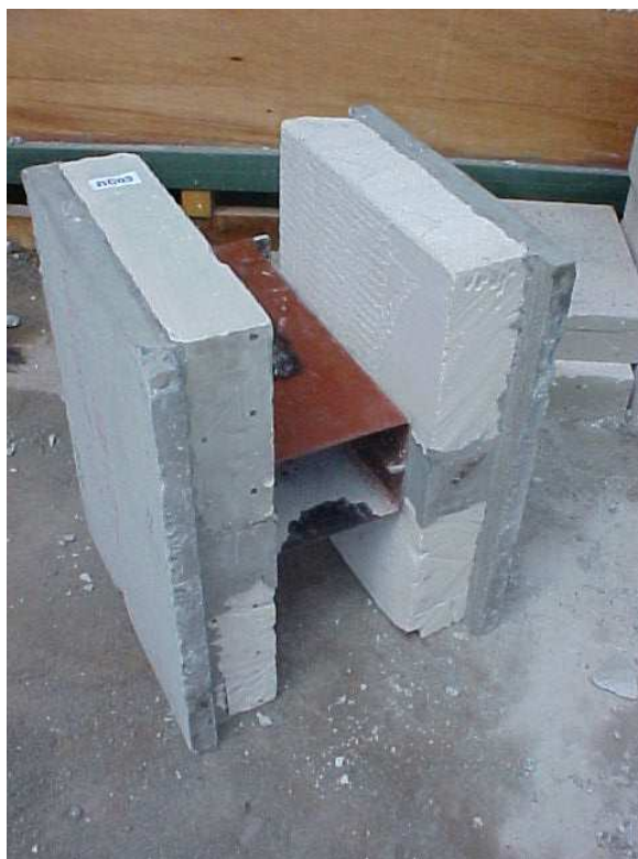
Figura 3.10 – Detalhes de fabricação dos modelos “ push out ”: modelo concretado
