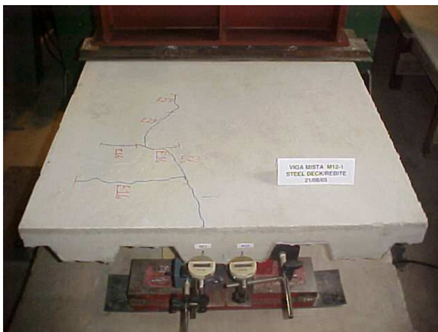
Figura 4.23 – Fissuras na laje e detalhe dos relógios comparadores na extremidade do modelo VM-M12-1
