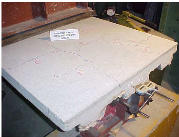
Figura 5.80 – Fissuras do modelo VMM12-1 durante ensaio, notando-se também o carregamento em linha em toda a largura da laje e a fissura longitudinal central devida a este
