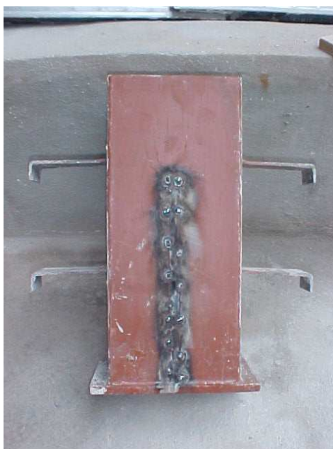
Figura B.5 – Conector U após ensaio “ push out ”, apresentando ligeira inclinação relacionada ao mecanismo de plastificação
