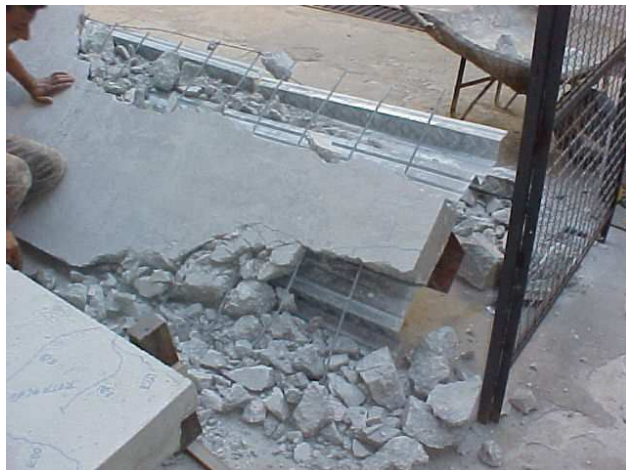
Figura B.6 – Detalhes da viga mista com os conectores rebite, deck metálico e armadura
