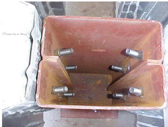
Figura B.9 – Vista superior do modelo “push out” com conector rebite
