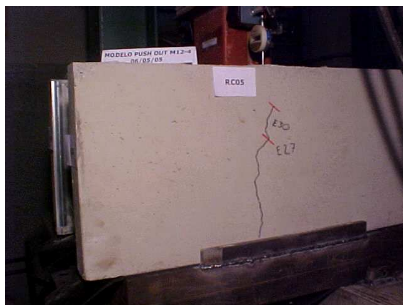
Figura 4.29 – Fissuras da laje do modelo M12-4
