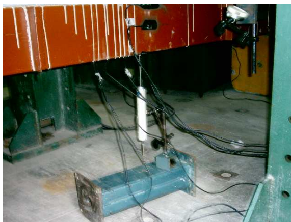
Figura 4.7 – Detalhe do transdutor de deslocamento (DT) e dos EER A1, A3 e A5 na lateral da viga
