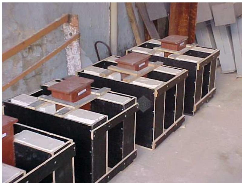
Figura 3.8 - Modelos PS-CCA 01, PS-CCA 02, PS-CCA 03 e PS-CCA 04, aguardando a concretagem da capa junto aos painéis CCA
