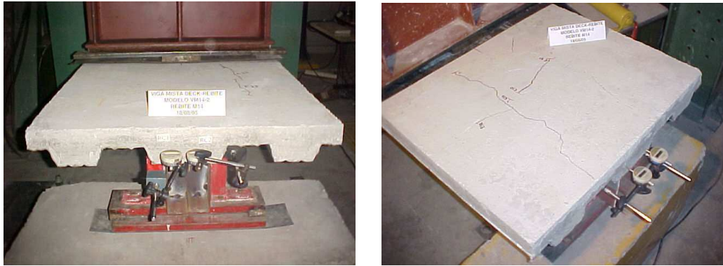
Figura 5.81 – Modelo VMM14-2 durante ensaio, notando-se o carregamento aplicado na largura do contato da laje com a viga metálica e algumas fissuras durante o ensaio
