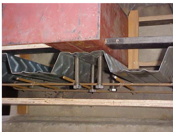
Figura 3.19 – Detalhe da armação dos modelos “ Push out ”
