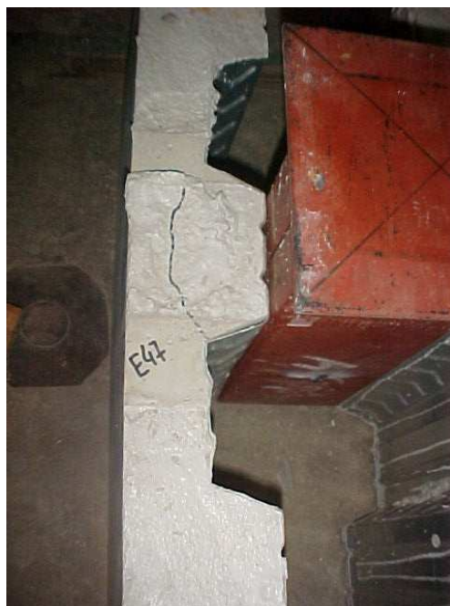
Figura 5.55 – Modelo “push out” M14-4 com fissuras típicas da Figura 5.51 (a)
