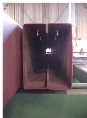
f) Vista interna da viga caixa
