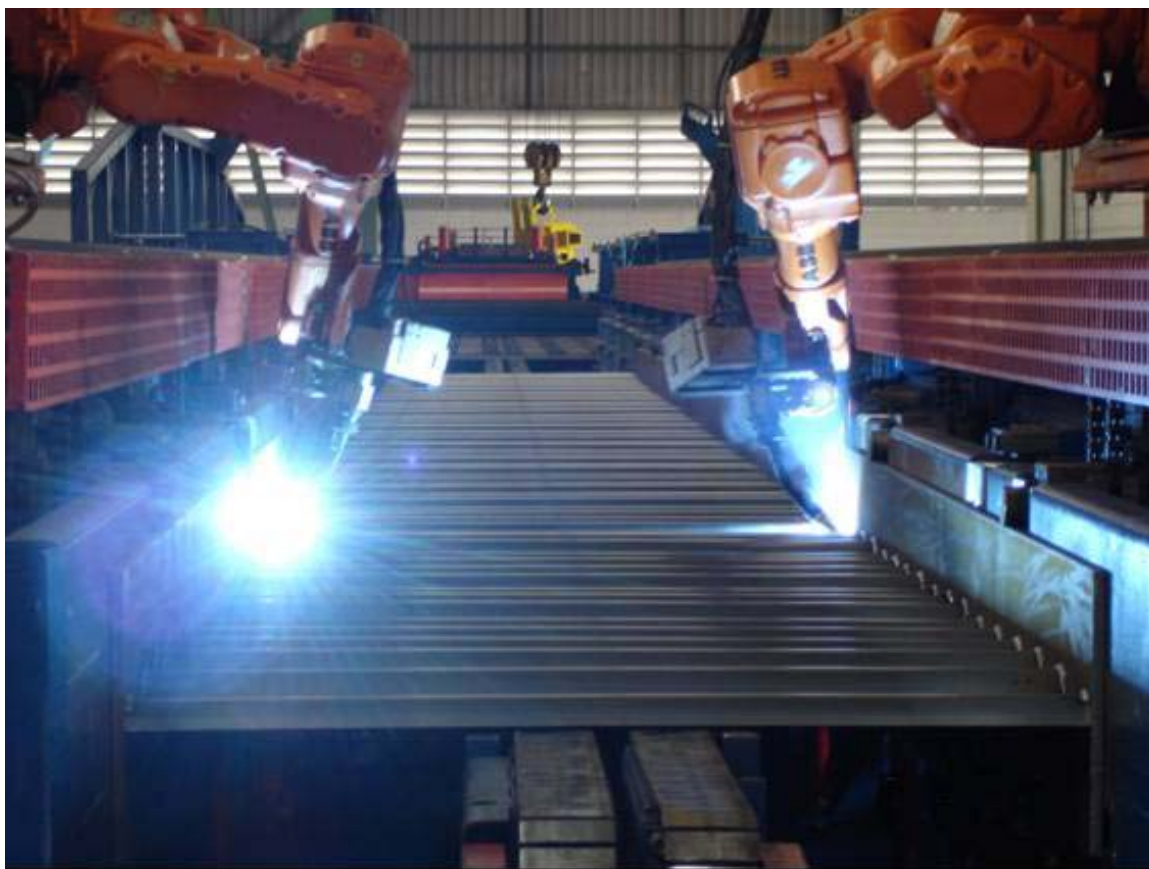
FIGURA 1.7 - Soldagem do perfil I de alma senoidal
