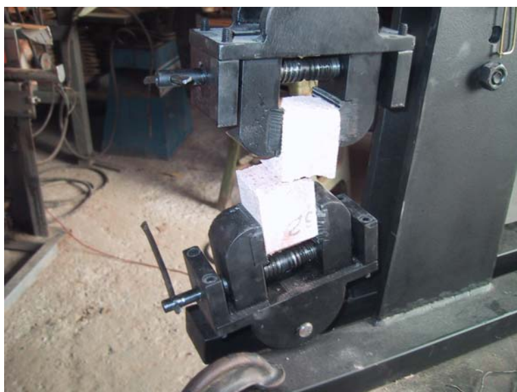
FIGURA 59 – Garra da máquina fixando um prisma de base retangular
