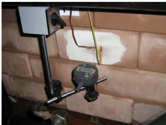
(a) Relógio comparador e EEs da face tracionada
