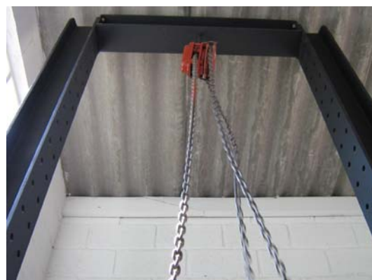
(d) talha para transporte da paredinha
