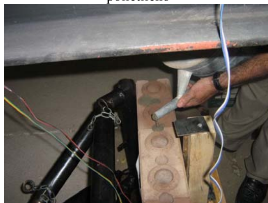
(b) placa de base com três lâminas de polietileno
