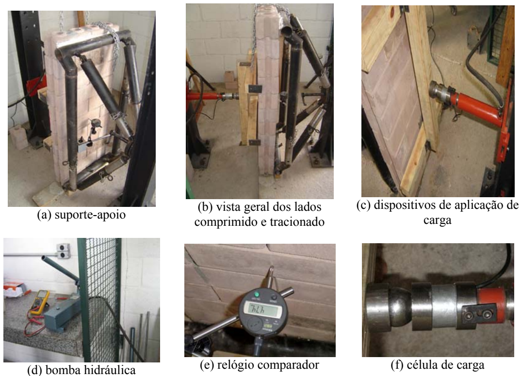
FIGURA 73 – Dispositivos de apoio e equipamentos utilizados na aplicação de cargas para o ensaio de flexão das paredinhas
