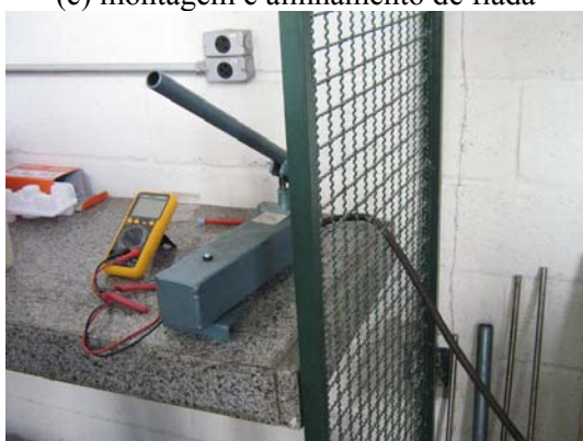
(e) Bomba hidráulica com manômetro digital
