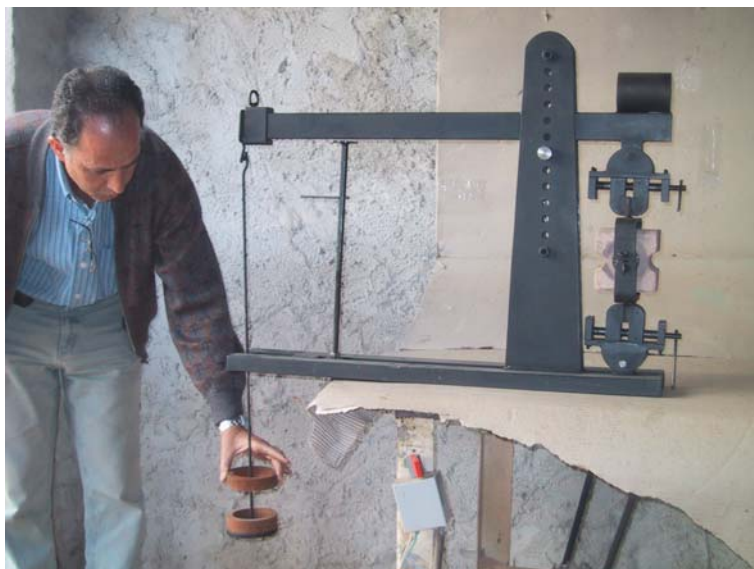
FIGURA 58 – Visão panorâmica da máquina de tração, no seu primeiro estágio
