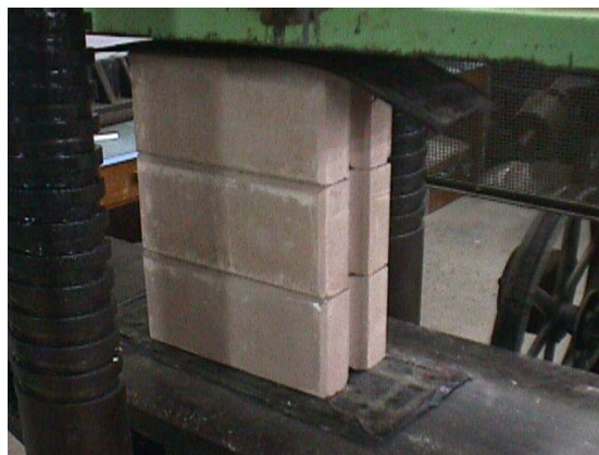
FIGURA 68 – Prisma típico com três fiadas e preparado para o ensaio de compressão
