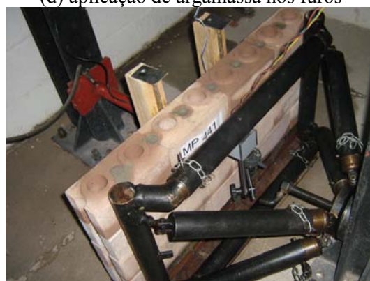
(f) dispositivo tridimensional para apoios verticais na série mp 44i
