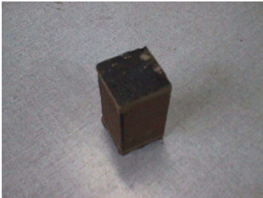
FIGURA 51 – Corpo-de-prova capeado com enxofre - PBR
