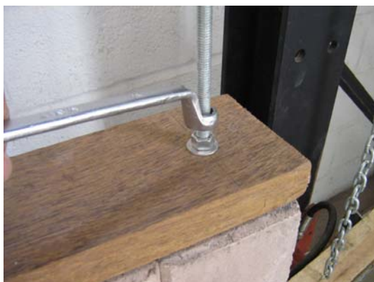
(a) placa de topo, parafuso, arruela e porca
