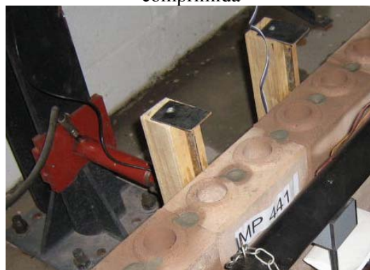
(d) Aplicadores de cargas com barras cilíndricas
