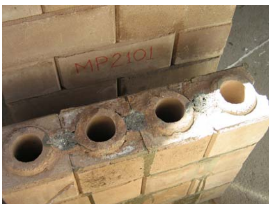
(c) ruptura do cilindro de argamassa
