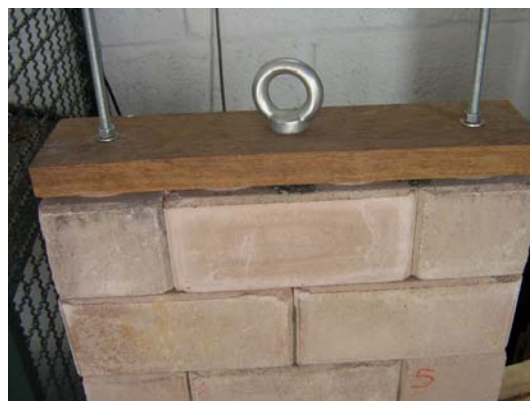
(b) placa de topo, parafusos e olhal
