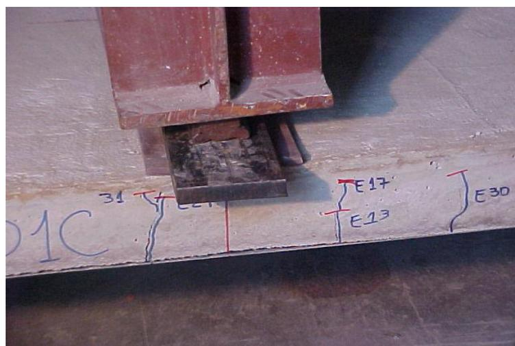
FIGURA 3.6 – Ocorrência de fissuras simetricamente dispostas e igualmente espaçadas
