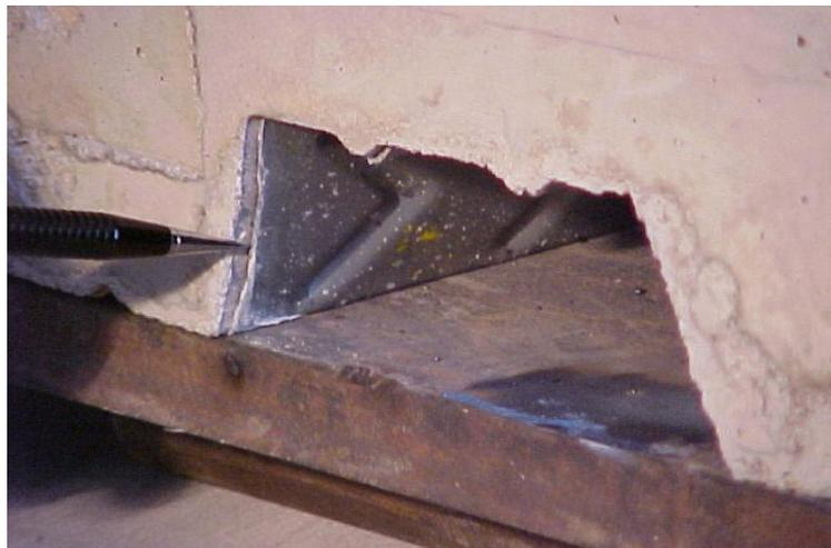
FIGURA 3.5 - Detalhe do deslocamento horizontal relativo entre a fôrma de aço e o concreto (end-slip)
