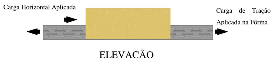
FIGURA 6.6 - Ensaio em pequena escala da laje mista com tração na fôrma - *tension-push test*
