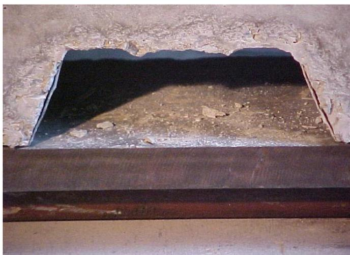
FIGURA 3.8 – Seção transversal da extremidade do modelo após colapso
