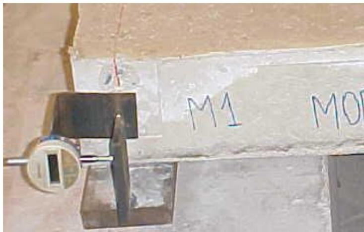
FIGURA 2.7 – Detalhe da medição do deslizamento relativo de extremidade
